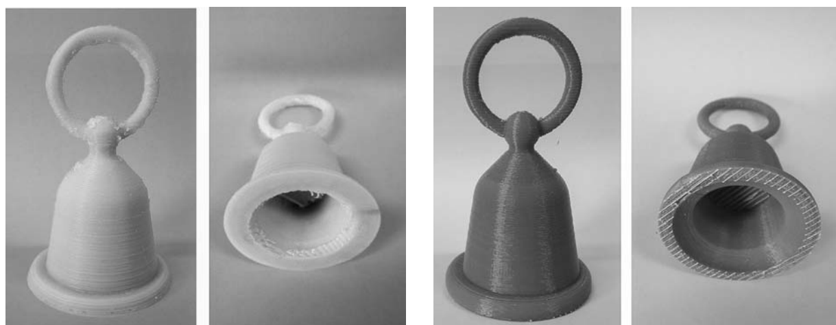
図7 サポート材を取り除いた3Dモデル(左Blade-1, 右da Vinci 1.0 AiO)
