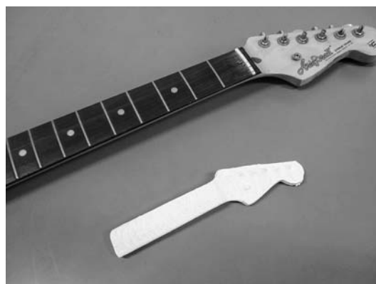
図12 出力された3Dモデル（1/2スケール）と実物との比較
