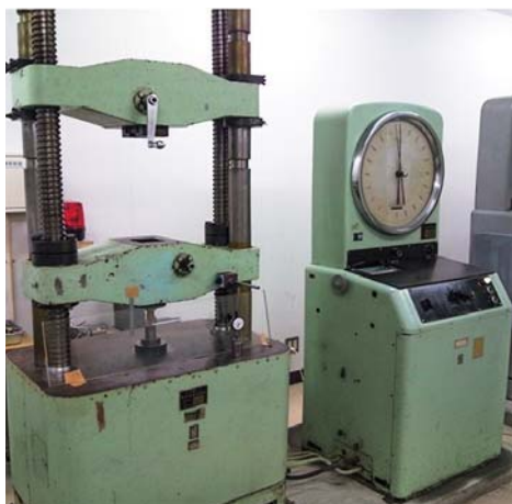
図1. 東京衡機製50t 油圧万能試験機 (本学材料力学実験室 林研究室)
