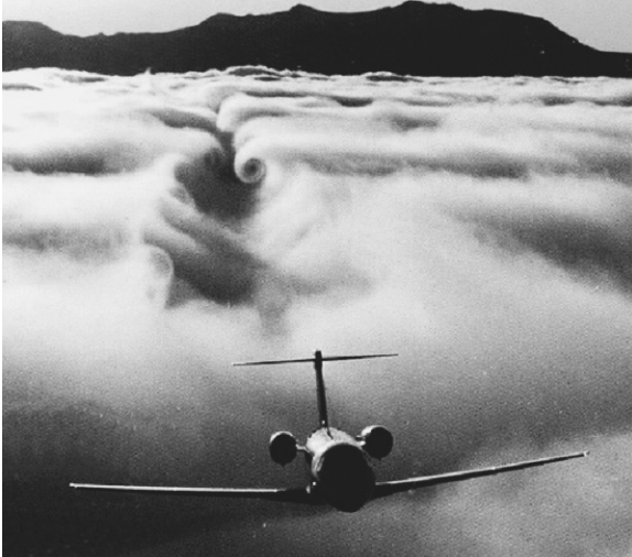
図3 (10) 湖面に発生した霧の直上を飛行する航空機と翼端渦
