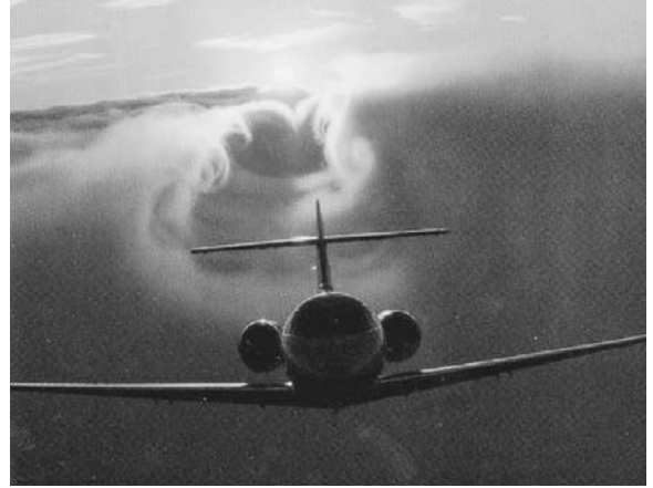
図4 (11) 湖面に発生した霧の直上を飛行する航空機と吹き降ろし
