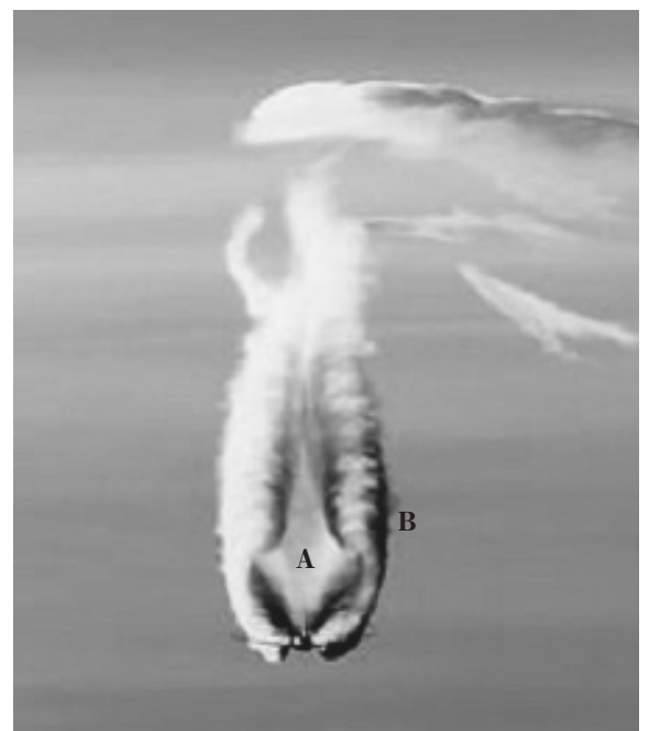
図6 (13) 航空機が発生した雲によって可視化された吹き降ろしと翼端渦の形成
