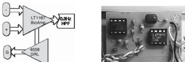
Fig. 2 EMG 導出部ブロック図と実装回路
