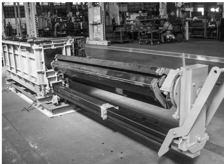
Fig. 14 改良されたコンクリート型枠
