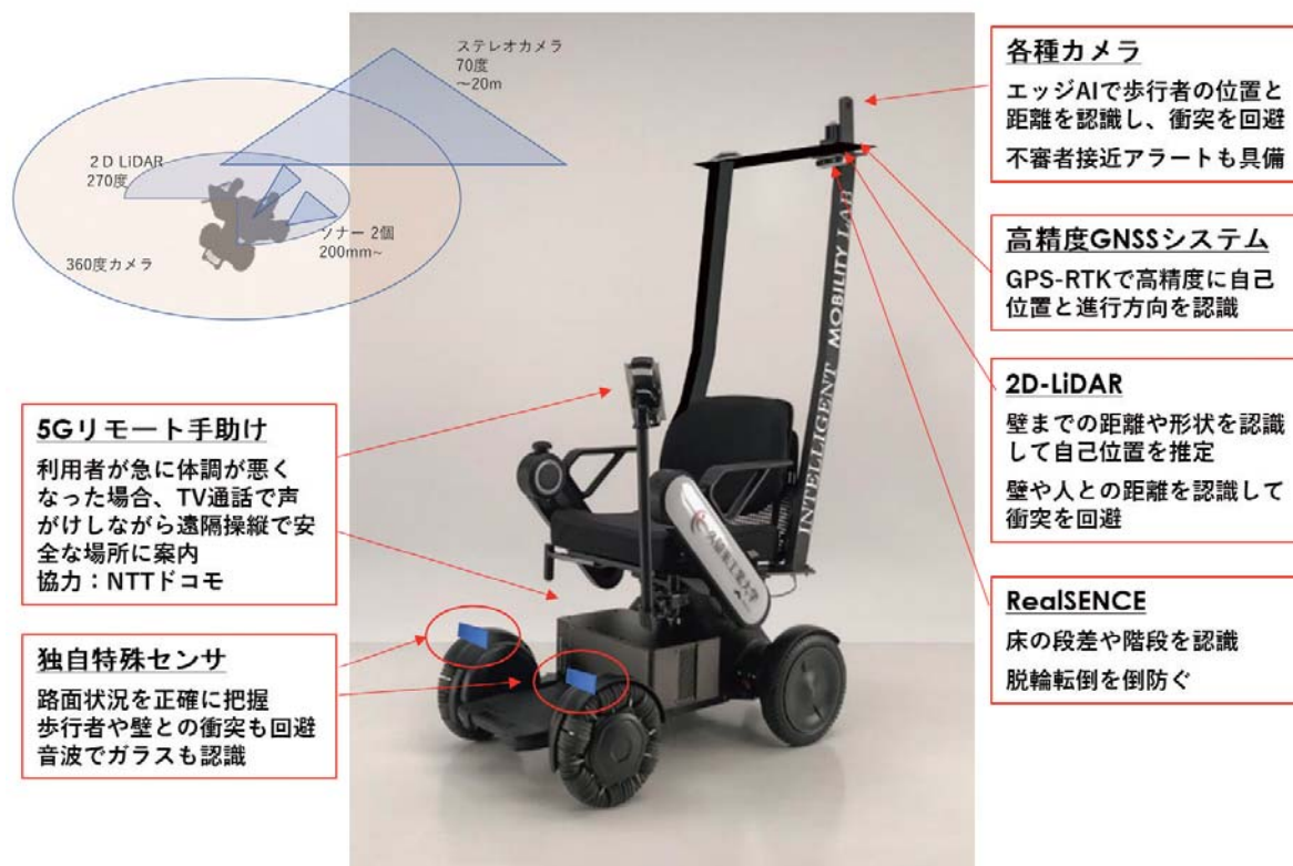
図 1. パートナーモビリティ構成図 (電動車いすを利用した例)
