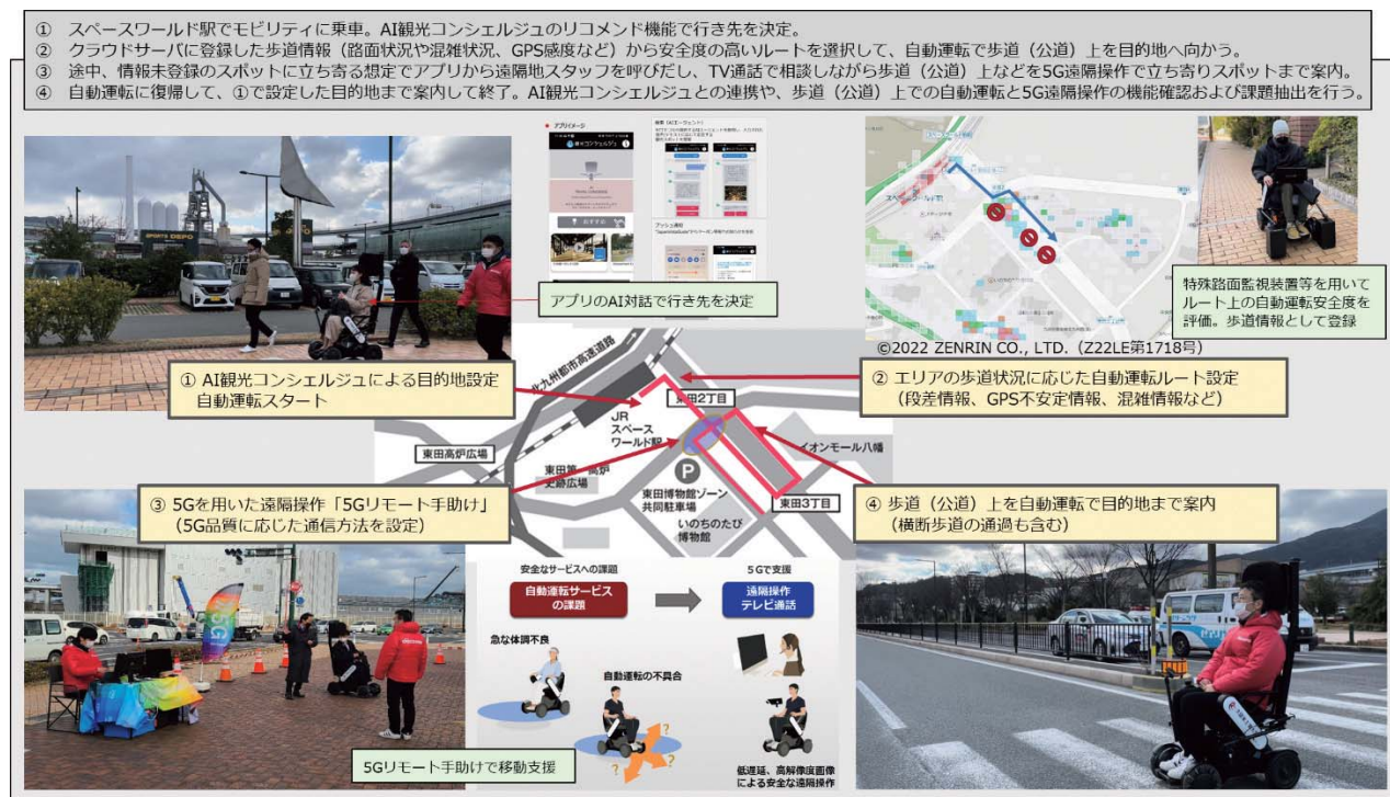
図8. スペースワールド駅周辺歩道（公道）での自動運転および5G遠隔操作の実証試験
