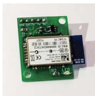
図11. RN42が実装された基板
