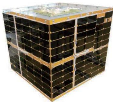
図13 超小型衛星 QSAT-EOS 外観
