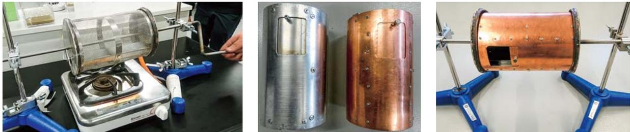
図1 はとむぎ精白粒専用焙煎器（左1号器，中央2号器，右3号器）
