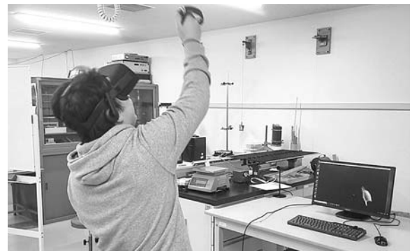
図2：操作中の様子。HMDを装着し、両手のハンドコントローラを操作し、小惑星をつかもうとしている様子。
