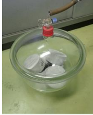
写真2 真空飽和处理
