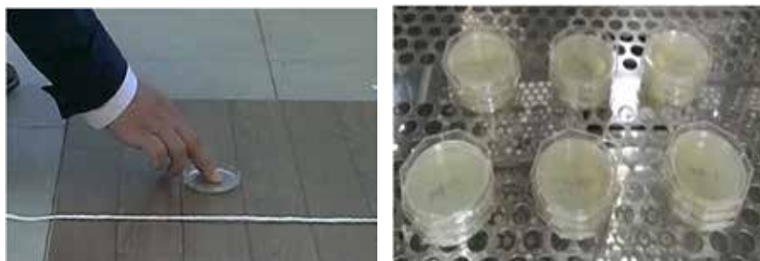
図4 スタンプ培地を用いた表面真菌採集の様子と培養の様子
