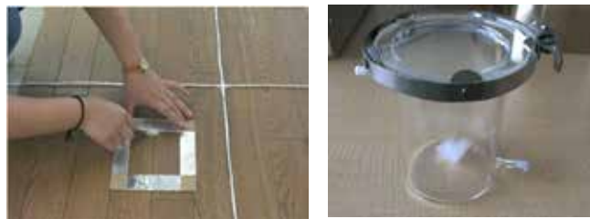
図3 PVC試験材の表面を拭き取る様子と石英ウールをマイクロチャンバーに入れた様子
