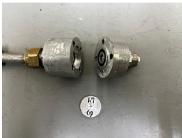
図 13 ソニックオリフィスとオリフィスプレートの写真（上側の二つの金具がソニックオリフィスでこの間に中央下のオリフィスプレートを内側に装着して使用する）
