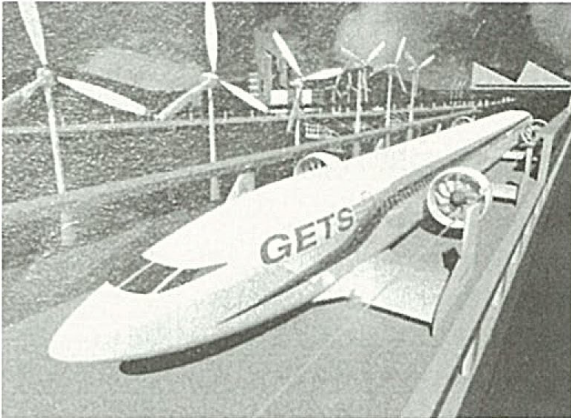
図9 2020年ソーラーエネルギーで時速500km 走行予定のエアロトレイン
