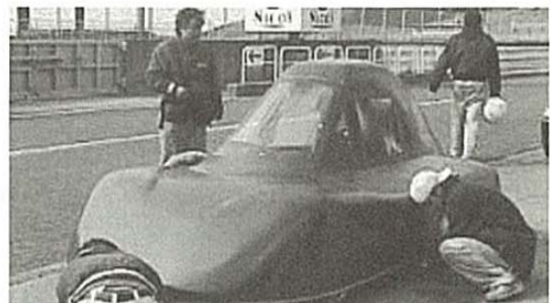
図9 完成したハイブリッドカーは燃費53km/リットルを達成した（写真はオートポリスでのテスト走行を示す）
