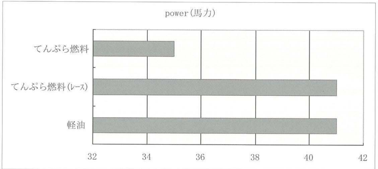
図10 3種類燃料のパワー(馬力)比較 ①てんぷら廃油からつくられたBDF, ②WRC用BDFと③軽油
