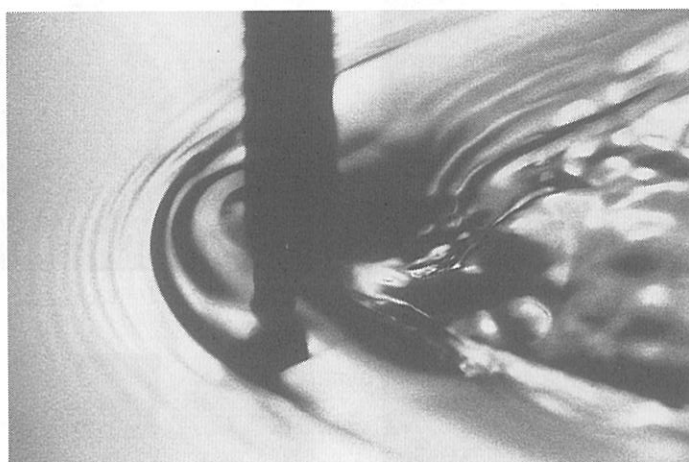
(a) d=1.1\text{cm} , U=40\text{cm/s} ( R=3.4 \times 10^3 , F=1.23 , W=44.5 )
