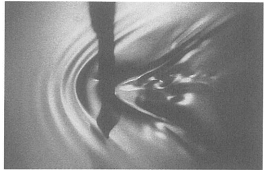
(d) d=0.60\text{cm} , U=28\text{cm/s} ( R=1.3 \times 10^3 , F=1.14 , W=11.4 )
